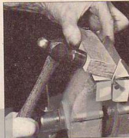
Fije la lengüeta en el tornillo de banco con un pasador. A continuación utilice un martillo de cabeza redonda y un bloque de madera para doblar bien las lengüetas alrededor del pasador
